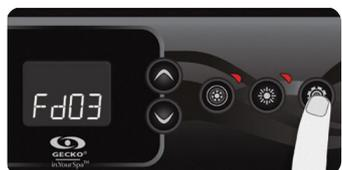
Non disponible sur les systèmes à cycle de purge uniquement. L'écran affichera **Fdxx**, « xx » représentant la durée en heures du cycle de filtration. Utilisez la touche **Haut/Bas** pour ajuster la durée. Utilisez la touche **Programme** pour passer au paramètre suivant, la fréquence du cycle de filtration ou de purge (**FF**).
