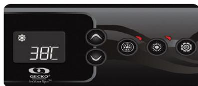
Notre Smart Winter Mode protège votre système du froid en mettant les pompes en marche plusieurs fois par jour afin d'éviter que l'eau ne gèle dans la tuyauterie. L'indicateur s'allume en cas de détection de gel et clignote lorsqu'un cycle de purge est en cours.
