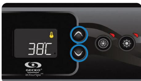
Appuyez sur la touche **Haut/Bas** pour régler la température de l'eau. Le réglage de température sera affiché pendant 2 secondes pour confirmer le nouveau réglage.
