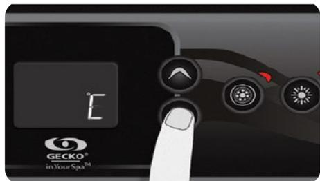
La température de l'eau peut être affichée soit en degrés Celsius (°C), soit en degrés Fahrenheit (°F). L'écran affichera C ou F. Utilisez la touche Haut/Bas pour modifier le réglage. Utilisez la touche Lumière pour sauvegarder tous les paramètres.
