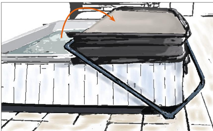
Pour soulever la couverture, appuyer avec le pied sur la barre inférieure et tirer la couverture avec la main
