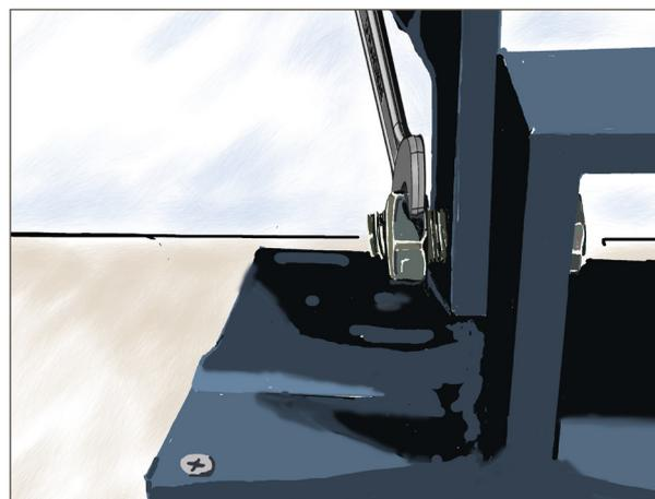
Monter le support des barres de levage et serrer l'écrou à la clé plate de 15
