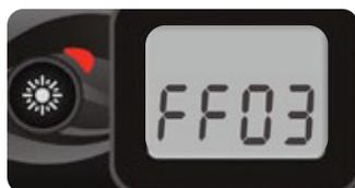
L'écran affichera FFxx, « xx » représentant le nombre de cycles par jour. Utilisez la touche Haut/Bas pour ajuster la fréquence. Utilisez la touche Lumière pour passer au paramètre suivant, le mode Économie (EP). Le voyant Cycle de filtration s'allume lorsque le cycle de filtration est en cours et clignote lorsqu'il est mis en pause.
