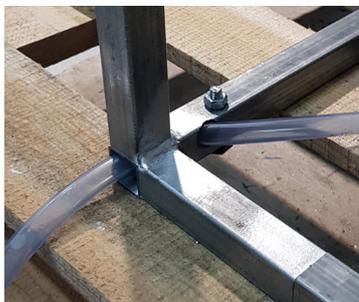
Raccourcir l'angle shape du tablier de 10 à 15 mm afin de pouvoir laisser passer le câble d'alimentation et le kit d'évacuation d'eau.
