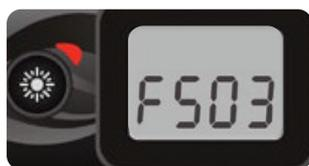
L'écran affichera FSxx, « xx » représentant l'heure de début du cycle. Utilisez la touche Haut/Bas pour ajuster les heures. Vous ne pourrez régler que les heures pas les minutes, pareil pour le cycle de filtration. Utilisez la touche Lumière pour passer au paramètre suivant, durée du cycle de filtration (Fd).
